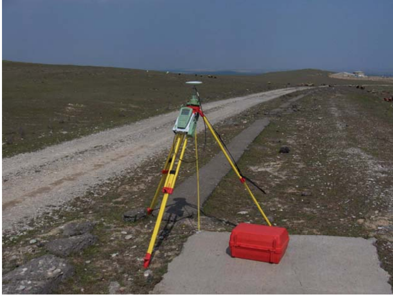
Şəkil 22.8. Fotoqrammetrik yer nəzarət nöqtələrinə GPS xidməti
