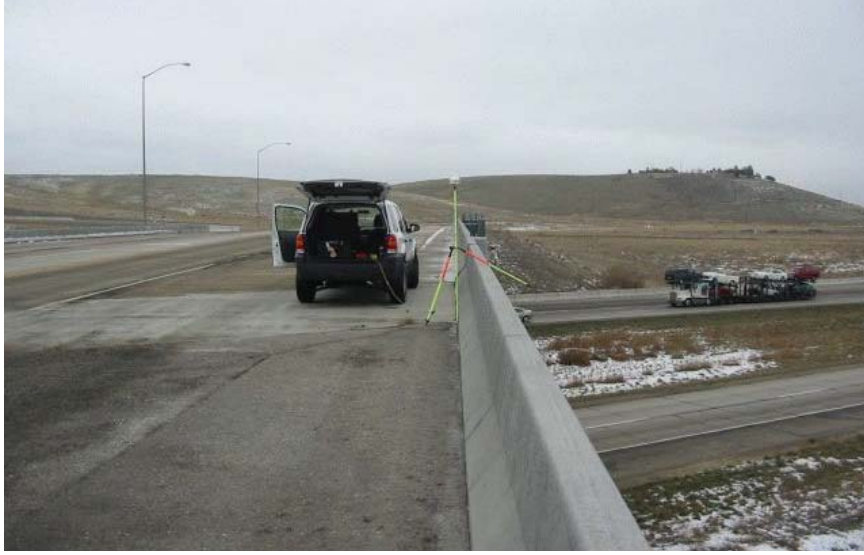
Şəkil 7.1. Yer nəzarət nöqtəsi körpü üzərində
