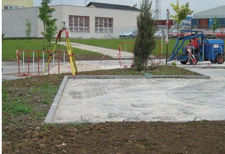
Şəkil 7.6. Nöqtə yaxşı rəng fərqi olan yerdə seçilmişdir, lakin burada sahənin bir hissəsi daşla yeni örtüldüyü üçün 3-4 il əvvəlki peyk şəkillərdə həmin örtük olmayacaqdır. Bu isə nöqtənin düzgün seçilməməsi deməkdir. Nöqtənin yerində rəng fərqi yoxdur.
