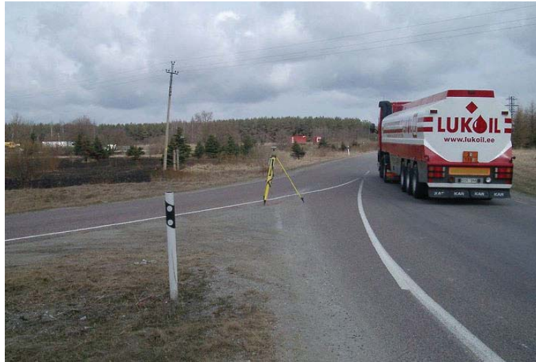
Şəkil. 7.11. Nöqtə peyk şəkli üzərində görünməyəcək, çünki ətrafda yer səthində rəng fərqi yoxdur.
