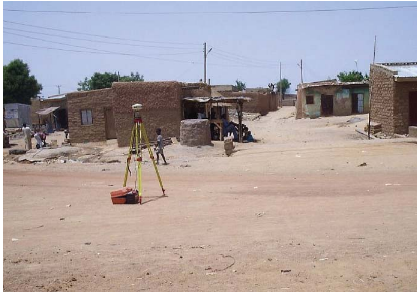
Şəkil 7.9. Nöqtə peyk şəkli üzərində görünməyəcək, çünki ətrafda rəng fərqi yoxdur.
