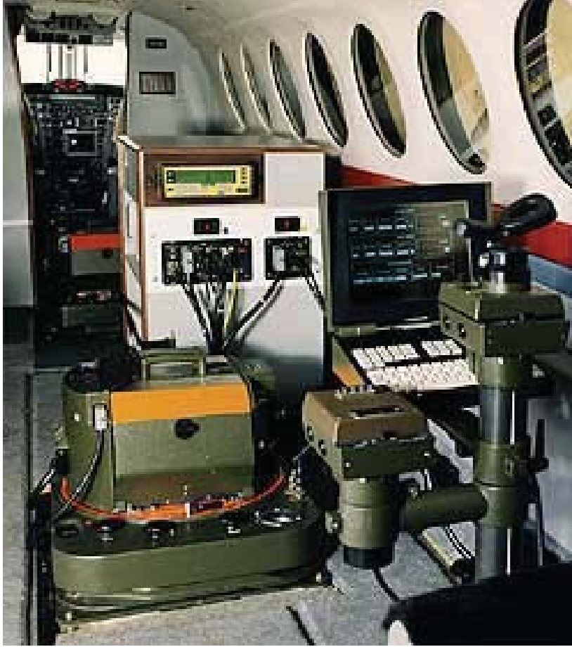
Şəkil 22.6. Təyyarədə quraşdırılmış xüsusi kamera (RC 30)
