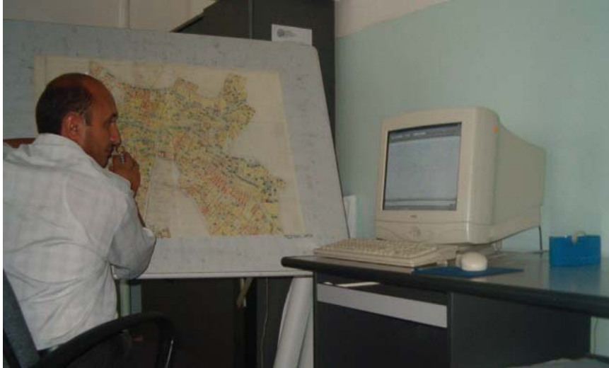
Şəkil 5.4. Genişformatlı (A0) digitayzer
