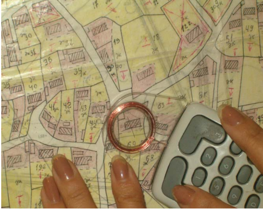
Şəkil 5.5. Genişformatlı digitayzərdə iş prosesi
