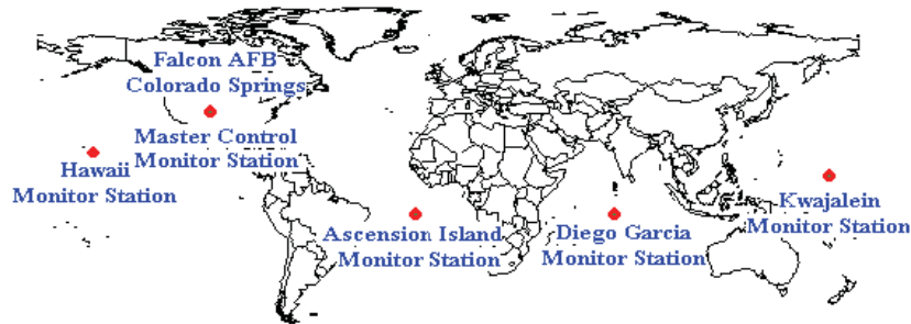
Şəkil 6.2. GPS peykləri ilə əks-rəbitəni və monitorinqi həyata keçirən 5 əsas nəzarət məntəqəsi
