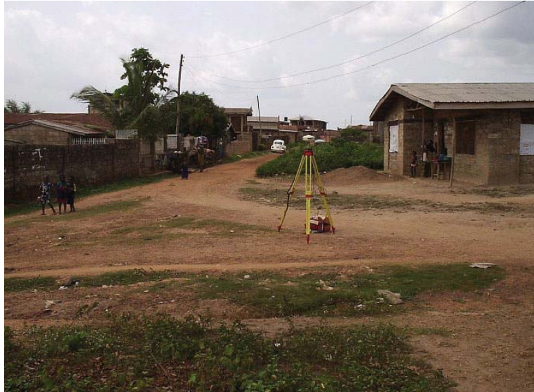
Şəkil.7.7. Nöqtə peyk şəkli üzərində görünməyəcək, çünki ətrafda rəng fərqi yoxdur. Otların rəngi isə qısa vaxt ərzində dəyişəcək.
