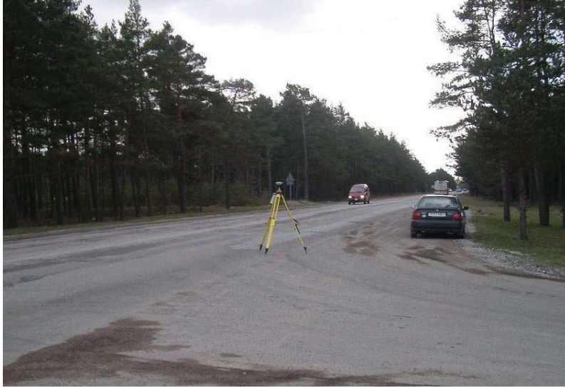
Şəkil 7.12. Nöqtə peyk şəkli üzərində görünməyəcək, çünki ətrafda yer səthində rəng fərqi yoxdur.
